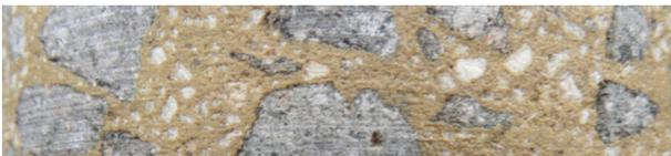
**Abb. 1** - Verschleißschicht mit hellen Zuschlagstoffen und durchsichtigem Bitumen
