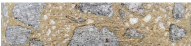
Fig. 1 - Tappeto con aggregati chiari e legante trasparente
